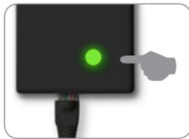
L'association des deux Freeplug n'est possible que si ces derniers sont sous tension. Une fois l'association des deux Freeplug réalisée, il vous est possible de débrancher et déplacer les Freeplug sans devoir procéder à une nouvelle association.
